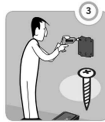
3 LÖCHER IN DIE WAND BOHREN UND HALTERUNG ANSCHRAUBEN
